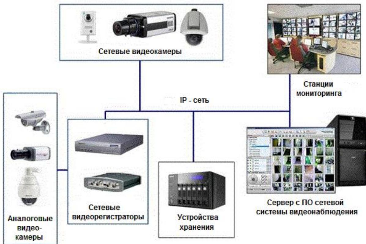
Рис. 6.2. Структурная схема сетевой системы видеонаблюдения.
