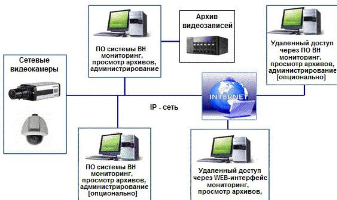
Рис. 6.17. Вариант системы видеонаблюдения на базе сервера
