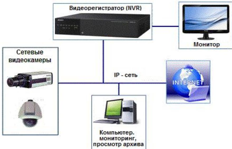
Рис. 6.18. Вариант системы видеонаблюдения на базе сервера
